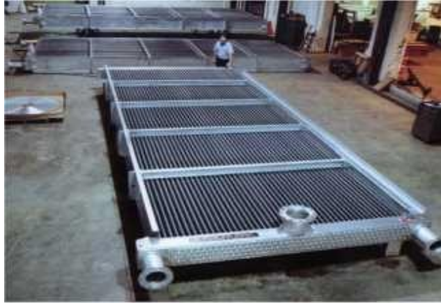
Figure II 11 Image d'un faisceau tubulaire
