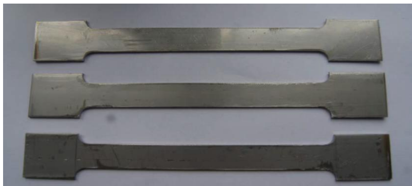
Figure III. 2: Eprouvettes d'essais de traction
