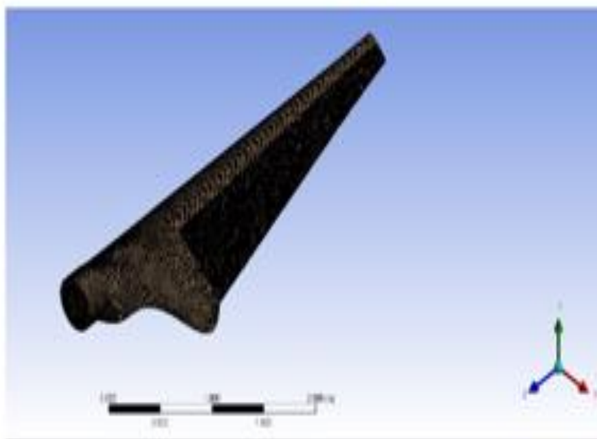
Figure II. 10 :le modèle CAO après maillage
