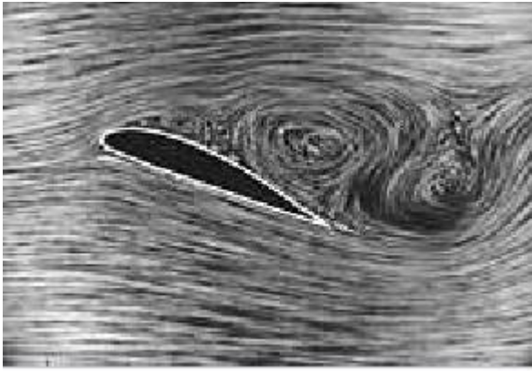
Figure III. 3: Profil d'aile en soufflerie en situation de décrochage[24]
