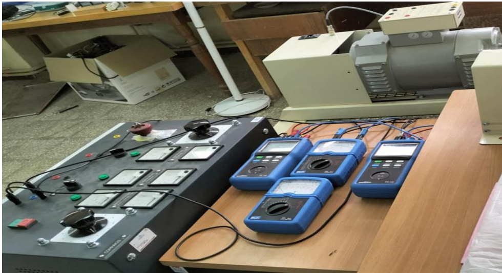
FIGURE I.7 – Schéma de montage expérimental pour l'essai à vide
