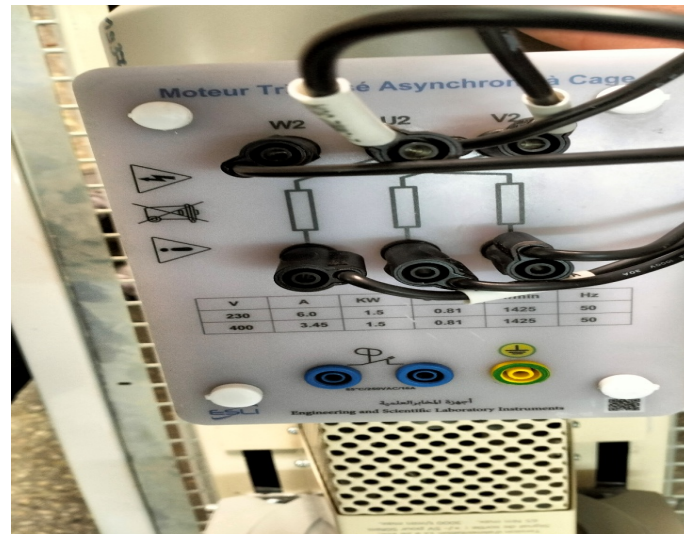
FIGURE IV.5 – Moteur asynchrone triphasé
