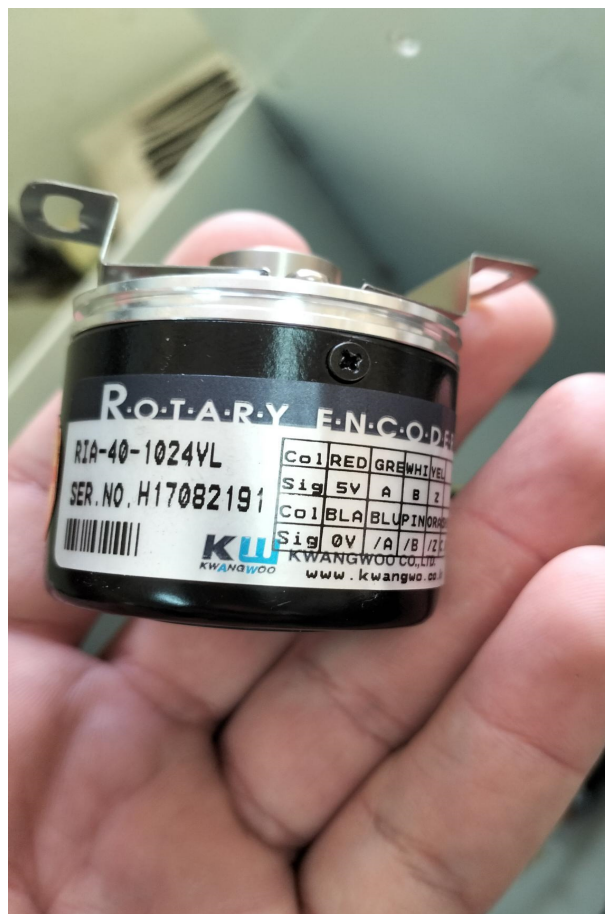
FIGURE 25 – Capteur de vitesse (encodeur)
