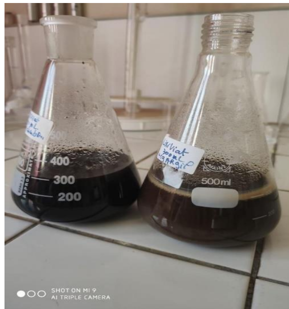
Figure 60 Lixiviat en présence du charbon actif (gauche), lixiviat en présence de l'argile (droite)
