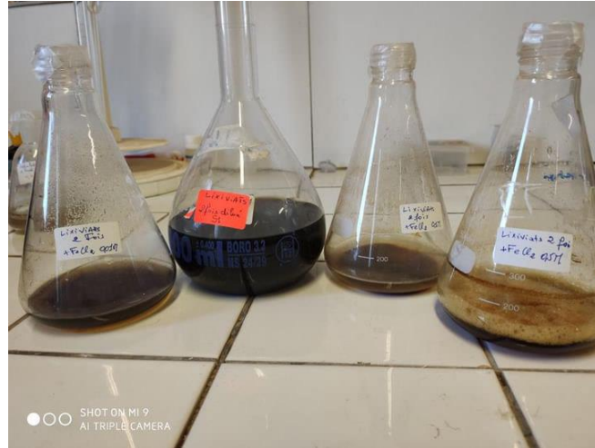
Figure 39 Résultat du traitement par le coagulant Fe(ClO_4)_3
