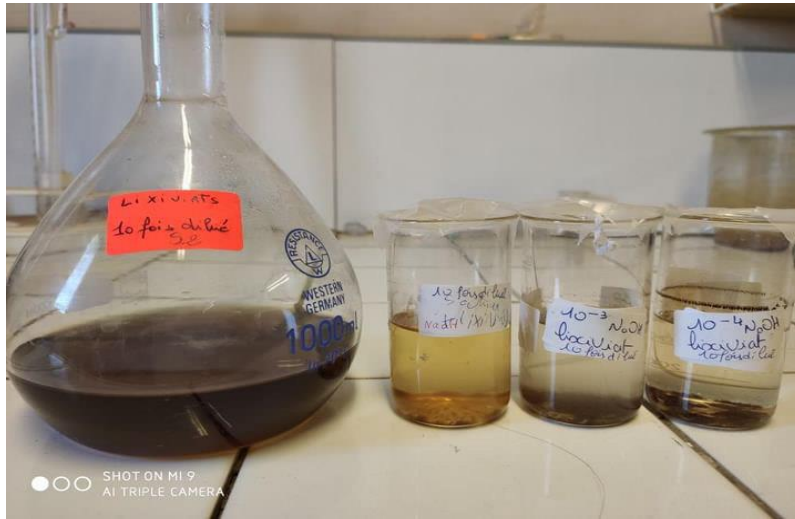
Figure 32 Résultat du traitement par le coagulant NaOH
