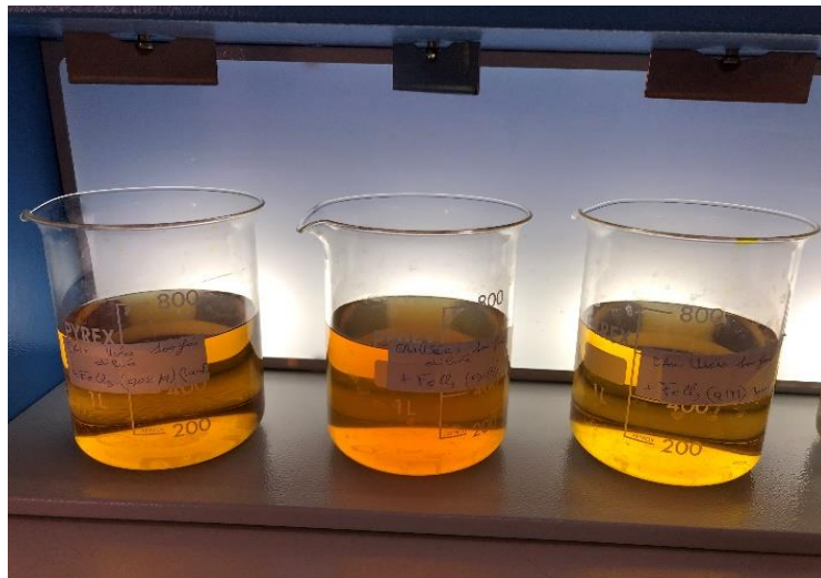
Figure 46 Résultat du traitement du lixiviat par le coagulant FeCl_3
