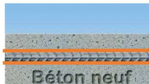
Figure 1.1 : Armatures en état de passivation dans le béton. [2]
