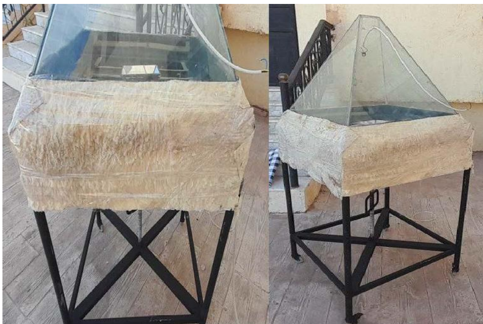
Figure 45 : Système d'isolation de distillateur
