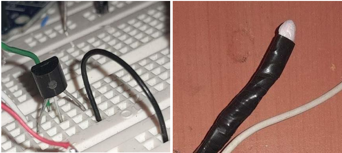
Figure 44 : Capteurs LM35 de l'air ambiante et de l'eau dans le bac
