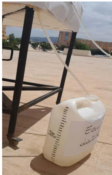
Figure 48 : Système de récupération de l'eau distillé
