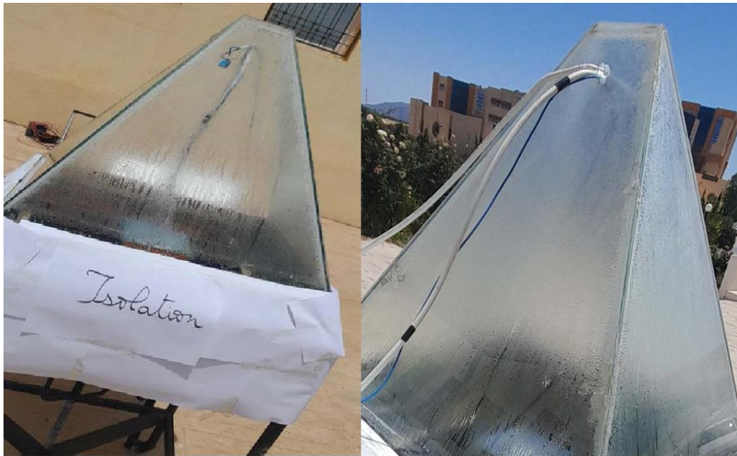
Figure 47 : Evaporation et condensation de l'eau
