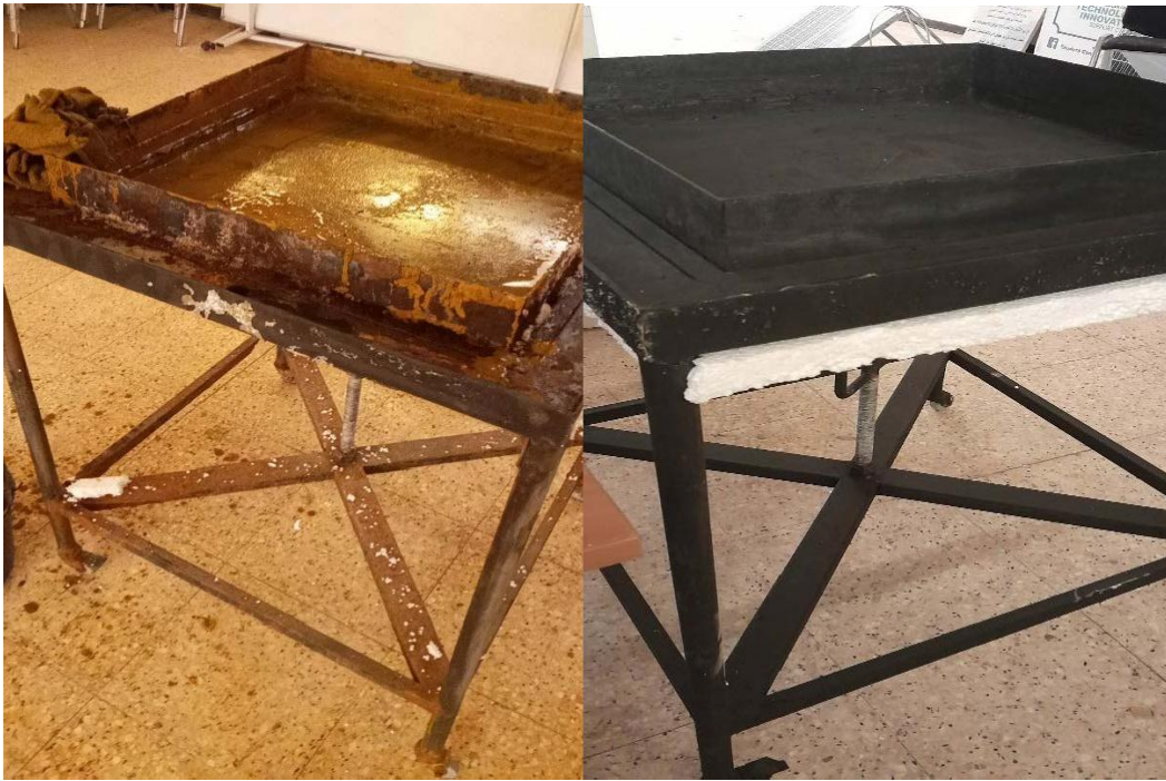
Figure 37 : Bac et Support de la table élévatrice avant et après le renouvellement
