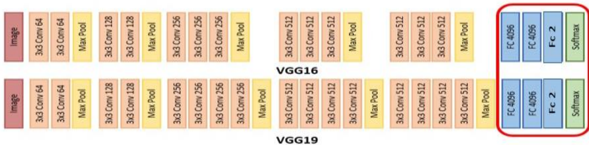
Figure 3.5 : L'architecture VGG16 et VGG19.
