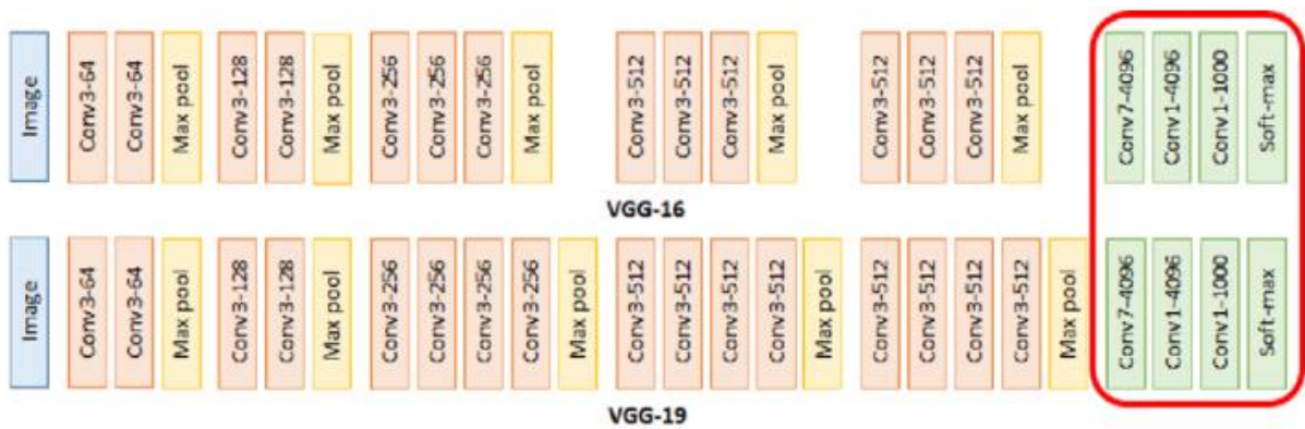
Figure 2.8 : Architectures de deux modèles VGG16 et VGG19.
