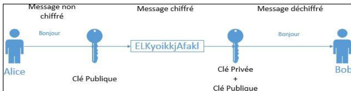
Figure 1.2 : Schéma de fonctionnement de la cryptographie asymétrique
