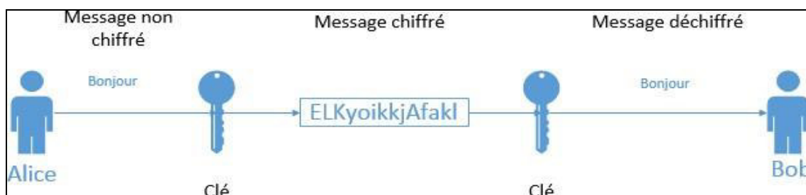
Figure 1.1 : Schéma de fonctionnement de la cryptographie symétrique
