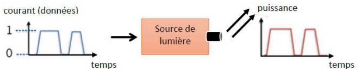
Figure I-7. Principe de base d'une modulation directe [13].
