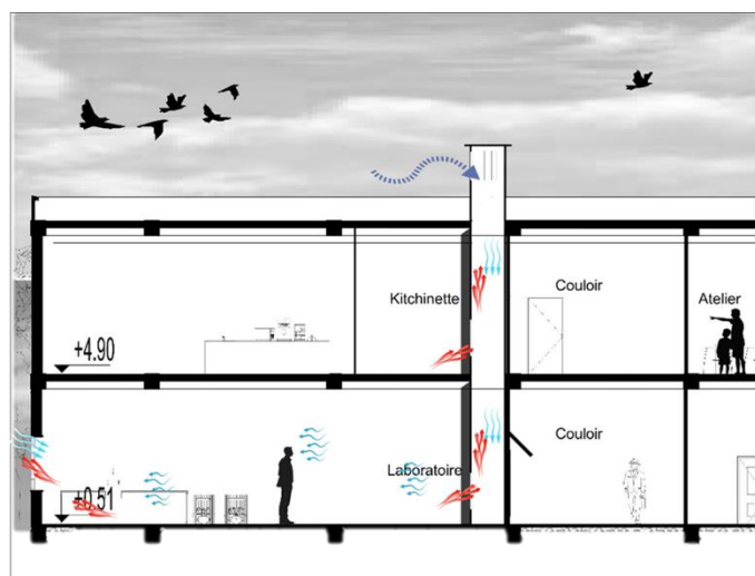
Planche 25 : Détails Low Tech –Tour à vents-
