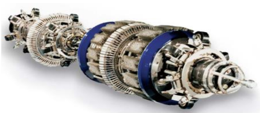
Figure 29 : Outil intelligent type "MagneScan HR" pour le contrôle par ultrasons des pipelines. ( Group limited Canada"-PII. 2004.)
