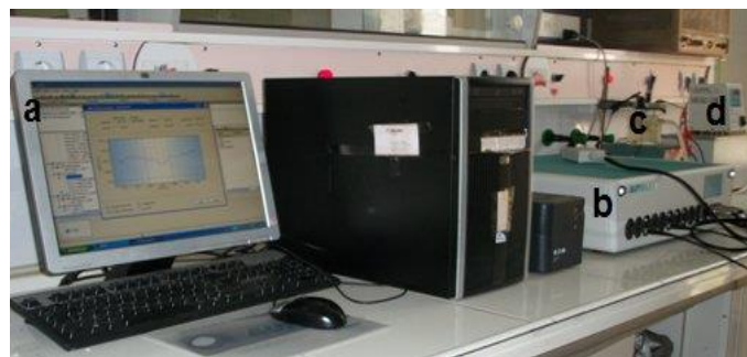
Figure 5 Dispositif de mesures électrochimiques a) Système d'acquisition b) Potentiostat – galvanostat c) Cellule électrochimiques d) Bain thermostaté
