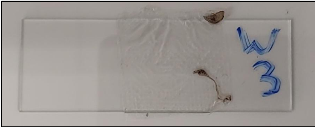
Figure 15 : La mise du morceau LDPE dégradé sur une lame
