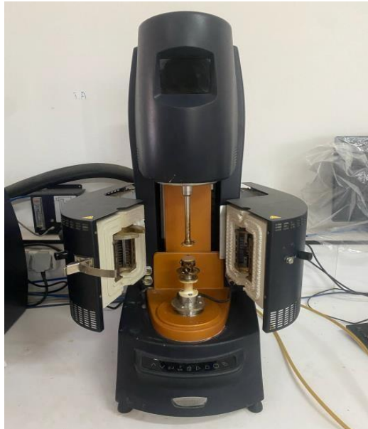
Figure III.11: Appareil de rhéologie utilisé pour l'analyse mécanique des gels
