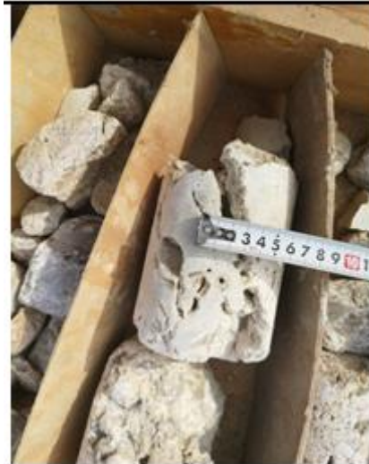
Photo 2. 2 : photographie d'un échantillon de calcaire vacuaire fissuré [15]
