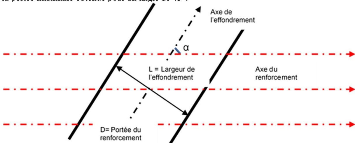
Figure 3. 13 : Orientation et portée du renforcement
