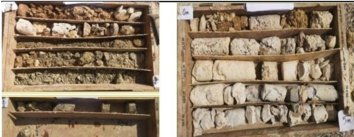
Photo 2. 4 : Photographies des caisses des sondages pour les anomalies n°8 et 2[15]
