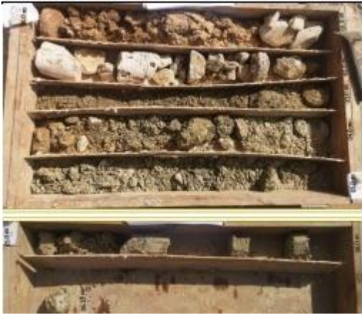
caisses des sondages pour les anomalies n°2 et 8
