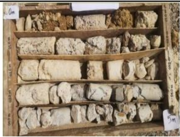
caisses des sondages pour les anomalies n°2 et 8
