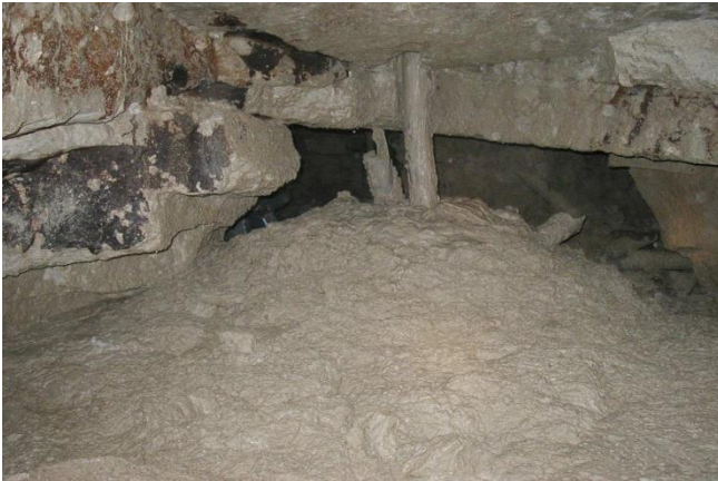
Figure 1. 25 : Comblement par déversement gravitaire [8]
