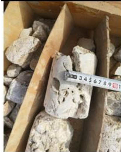
échantillon de calcaire vacuolaire fissuré
