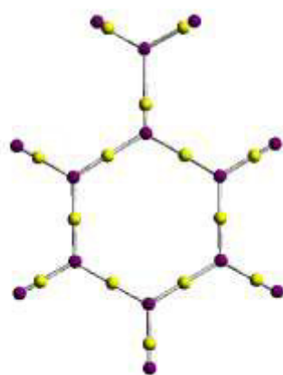
Figure I.2. Graphe moléculaire de l'aniline : Chemin de liaison en blanc, points critiques de liaison en jaune, et les attracteurs en violet, calculé au niveau MP2/aug-ccpVTZ [17]
