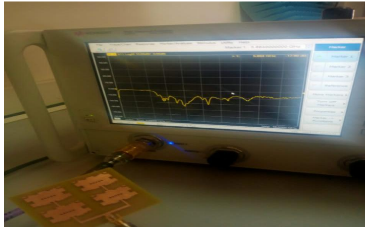
Figure IV.14: Test du réseau d'antennes reconfigurables à quatre éléments.
