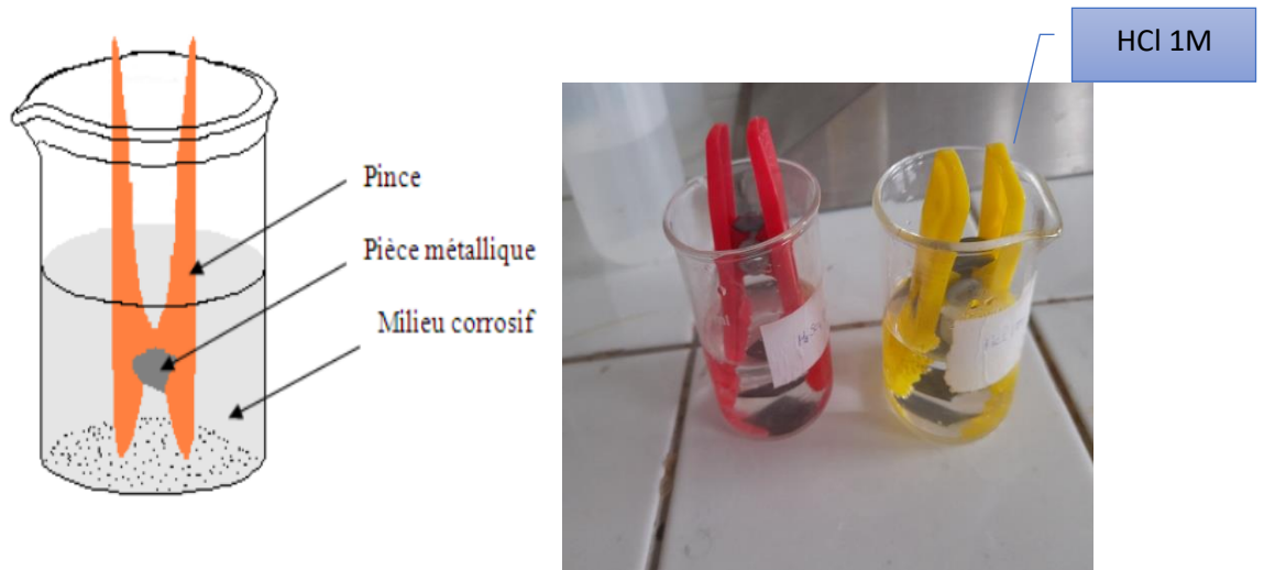
Figure 3.6 : position de l'acier dans le milieu corrosif
