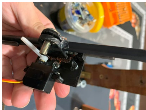
Figure II-9 : Support finale pour l'axe Z
