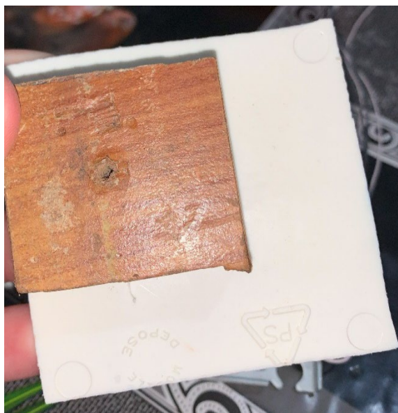
Figure II-12 : Le bout de la planche en bois collé avec la surface en plastique
