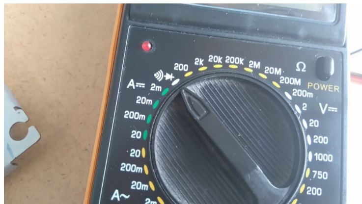
Figure II-4 : Multimètre en position court-circuit
