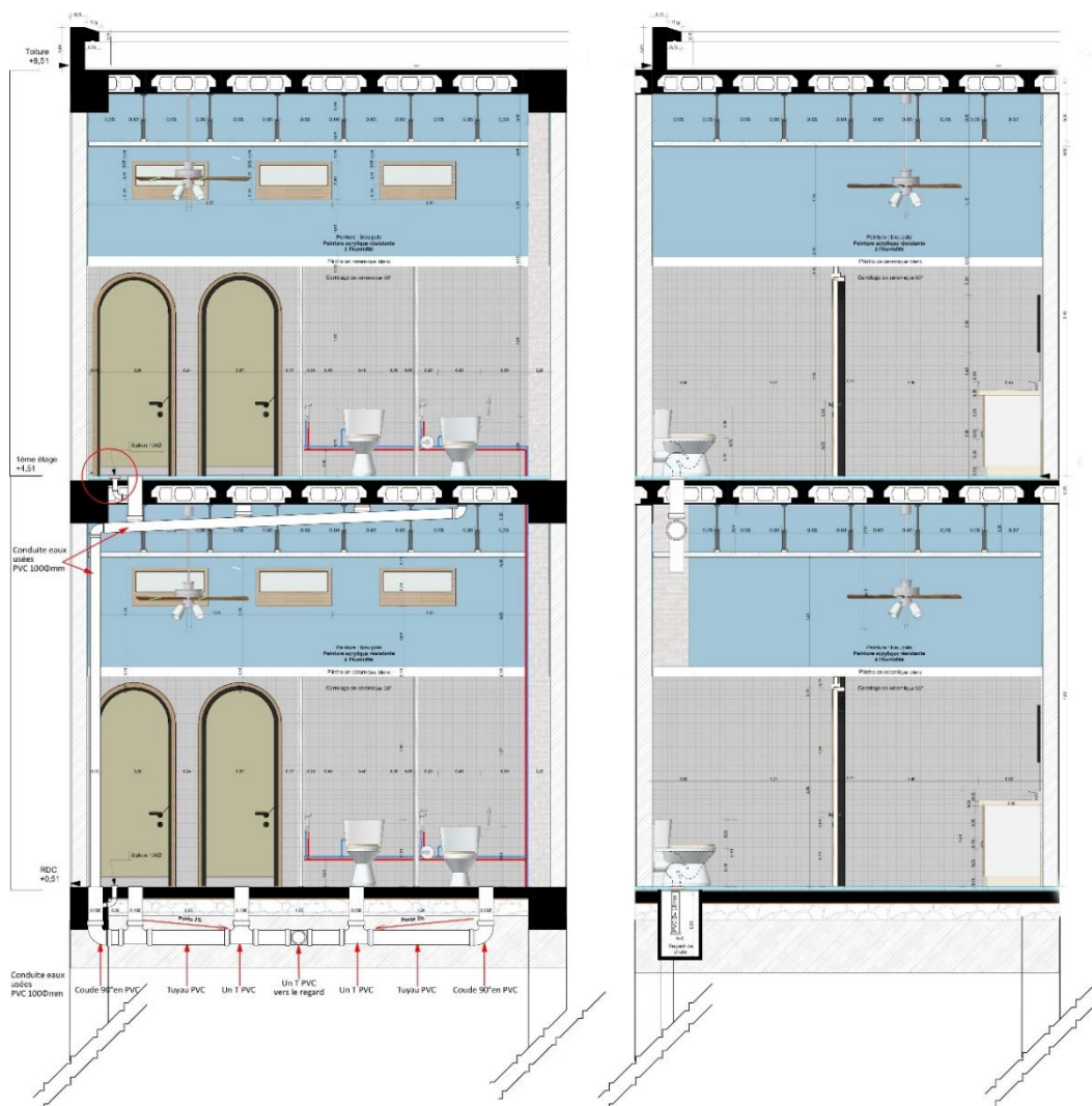
Figure 118 : Détails sanitaires (Source : auteur)
