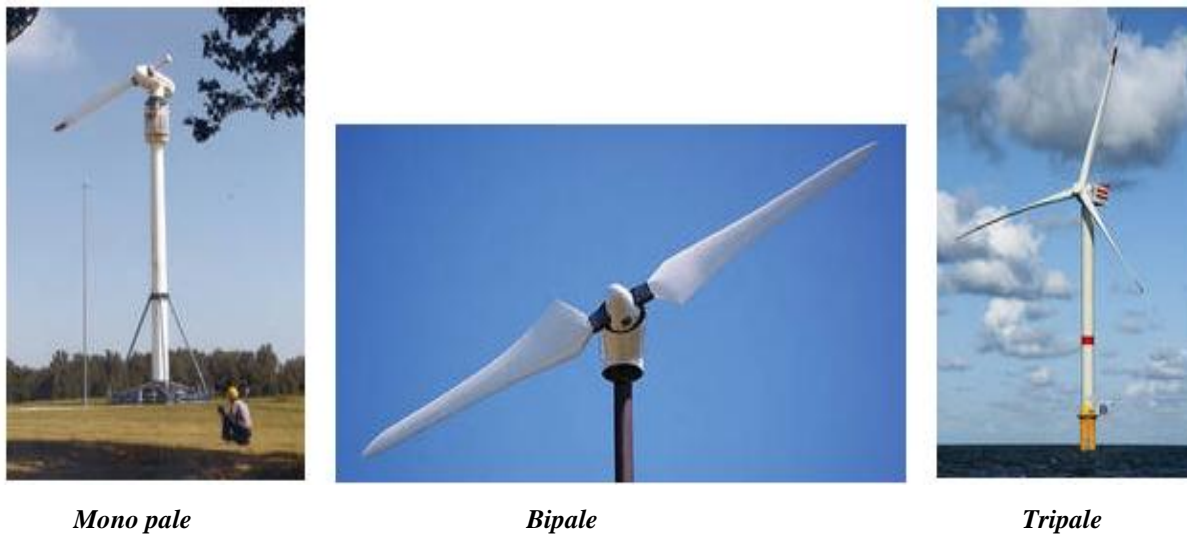
Figure (IV.3) : Types d'éolienne à axe horizontal [9]
