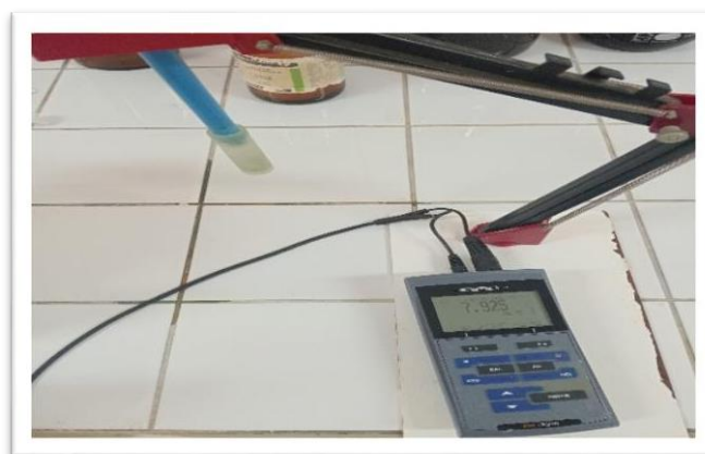
Photo. V.5: pH mètre de laboratoire.
