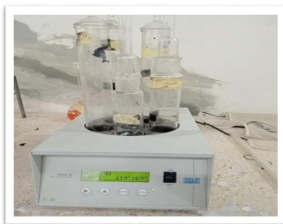
Photo. V.10: Bloc chauffant de laboratoire.
