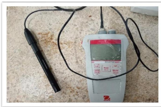
Photo. V.8: Oxymètre de laboratoire.
