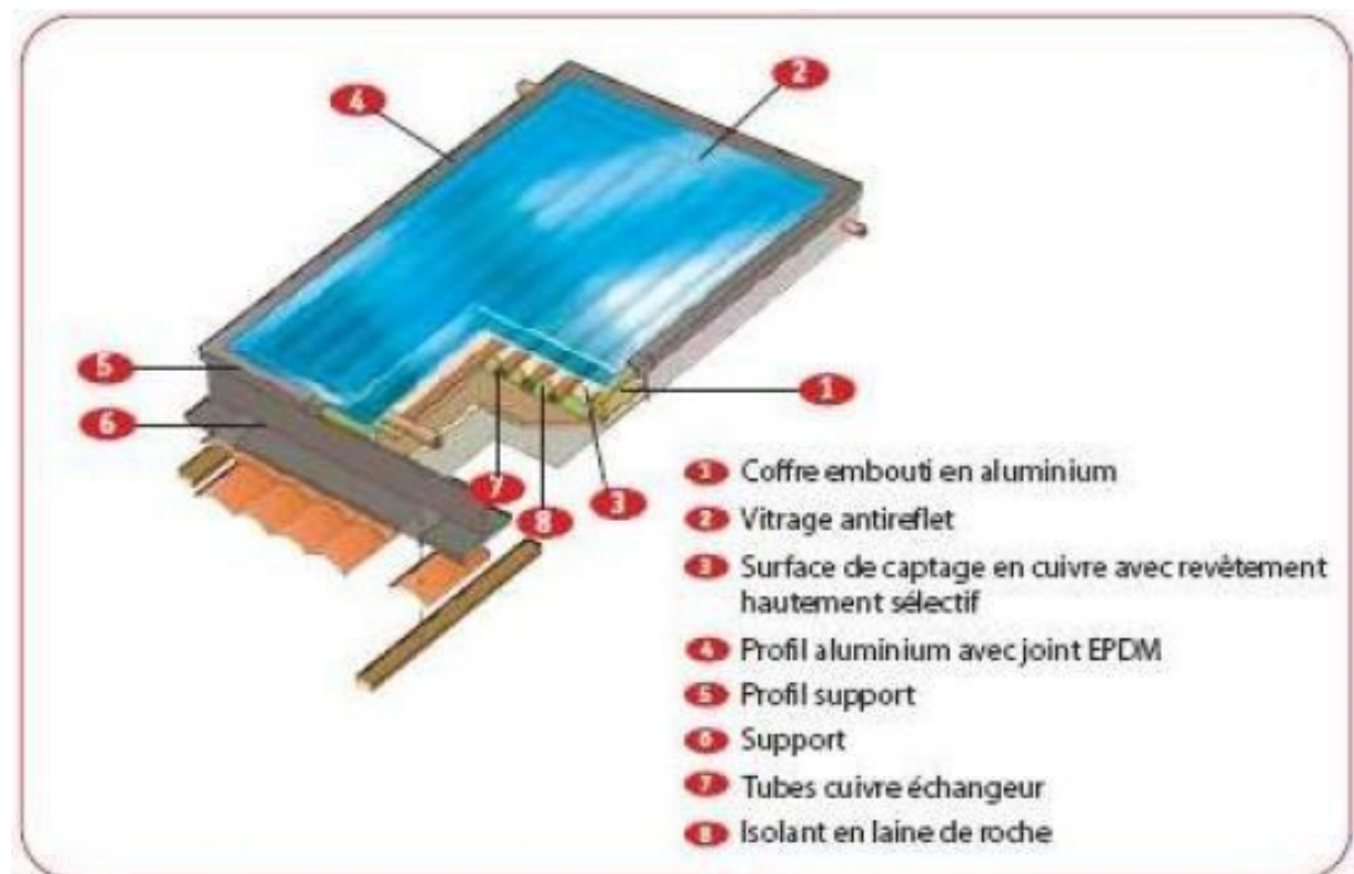
Figure II.3 : « Un capteur solaire thermique multicouche ». [14]
