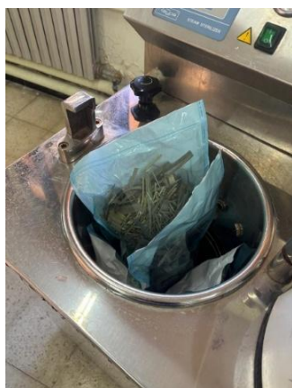
Figure III. 11: Conditionnement du substrat Avant autoclavage
