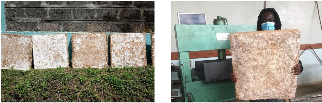
Figure I 17 : Panneaux d'isolation à base de mycélium développés par MycoTile au Kenya.[7]
