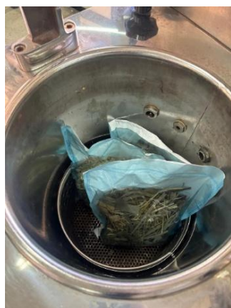
Figure III. 9: stérilisation du substrat a l'autoclave
