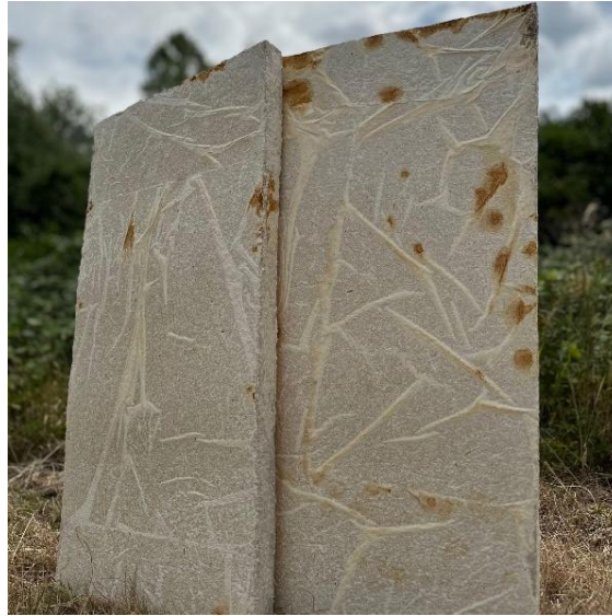
Figure I.19: Panneaux isolants et briques fabriqués à partir de mycélium.
