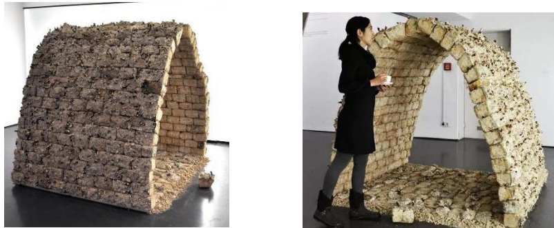
Figure I.11: Philip Ross et exemples de structures réalisées à partir de mycélium [1]
