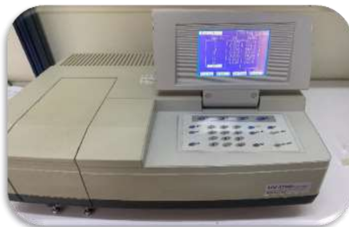
Figure 23 : spectrophotomètre de type PHARMASPEC 1700 visible UV-visible ( originale )
