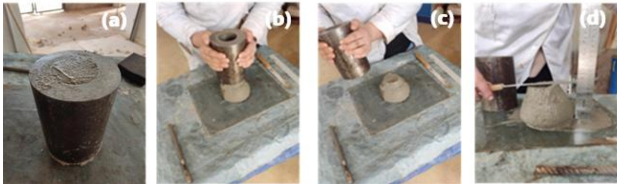
Figure III-9 : Etapes d'essai d'affaissement.
