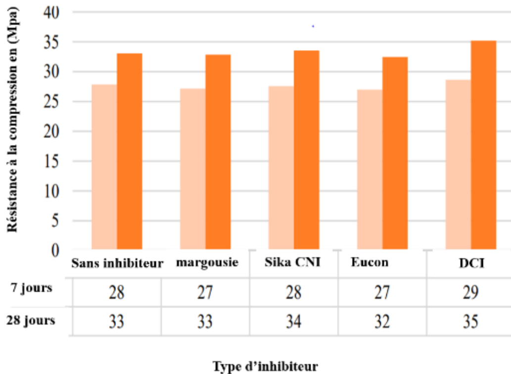
Figure II-2: La Résistance à la compression du mortier avec quatre inhibiteurs (margousier, Sika CNI, Eucon CIA et DCI) (Valdez-Salas et al., 2021).
