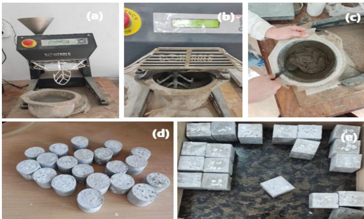
Figure III-8 : Protocoles de fabrication de mortier : (a) Malaxeur, (b) Malaxage du mortier, (c) Mélange manuel, (d) Les échantillons cylindriques et (e) Les échantillons cubiques.
