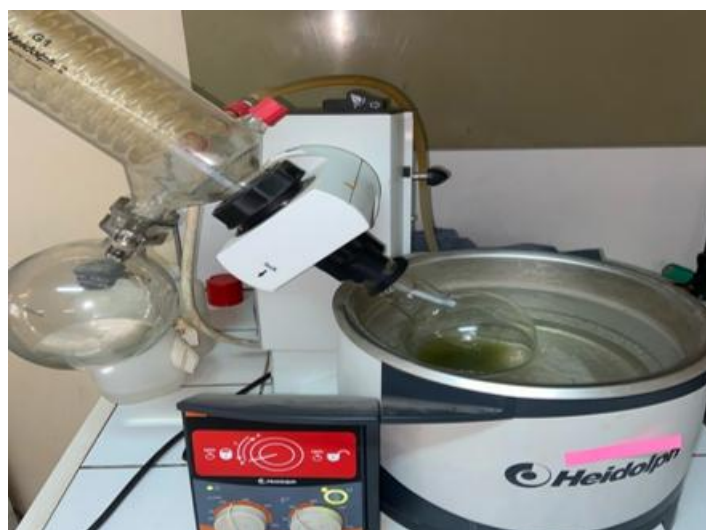
Figure 5 : Evaporation de l'extrait par Rotavapeur (photo personnelle)
