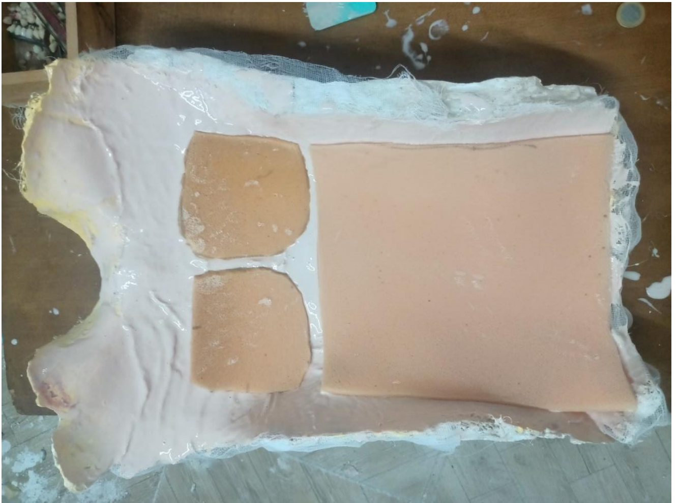
Figure 27 : versement de silicone et mettre de l'éponge sur le moule
