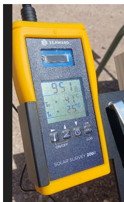
FIGURE 4.5 – Mesure de l'irradiance et des températures du PV
