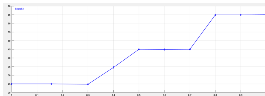
FIGURE 3.16 – Profil thermique progressif appliqué au module photovoltaïque
