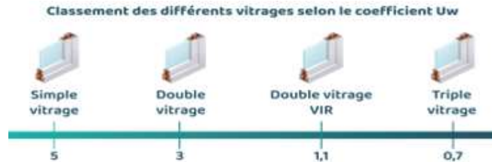
Figure I. 9 : Classements de vitrages. . [18]
