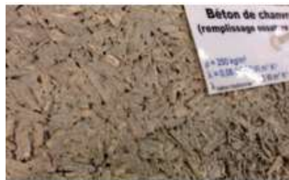
Figure II. 14 : Béton en chanvre. . [42]
