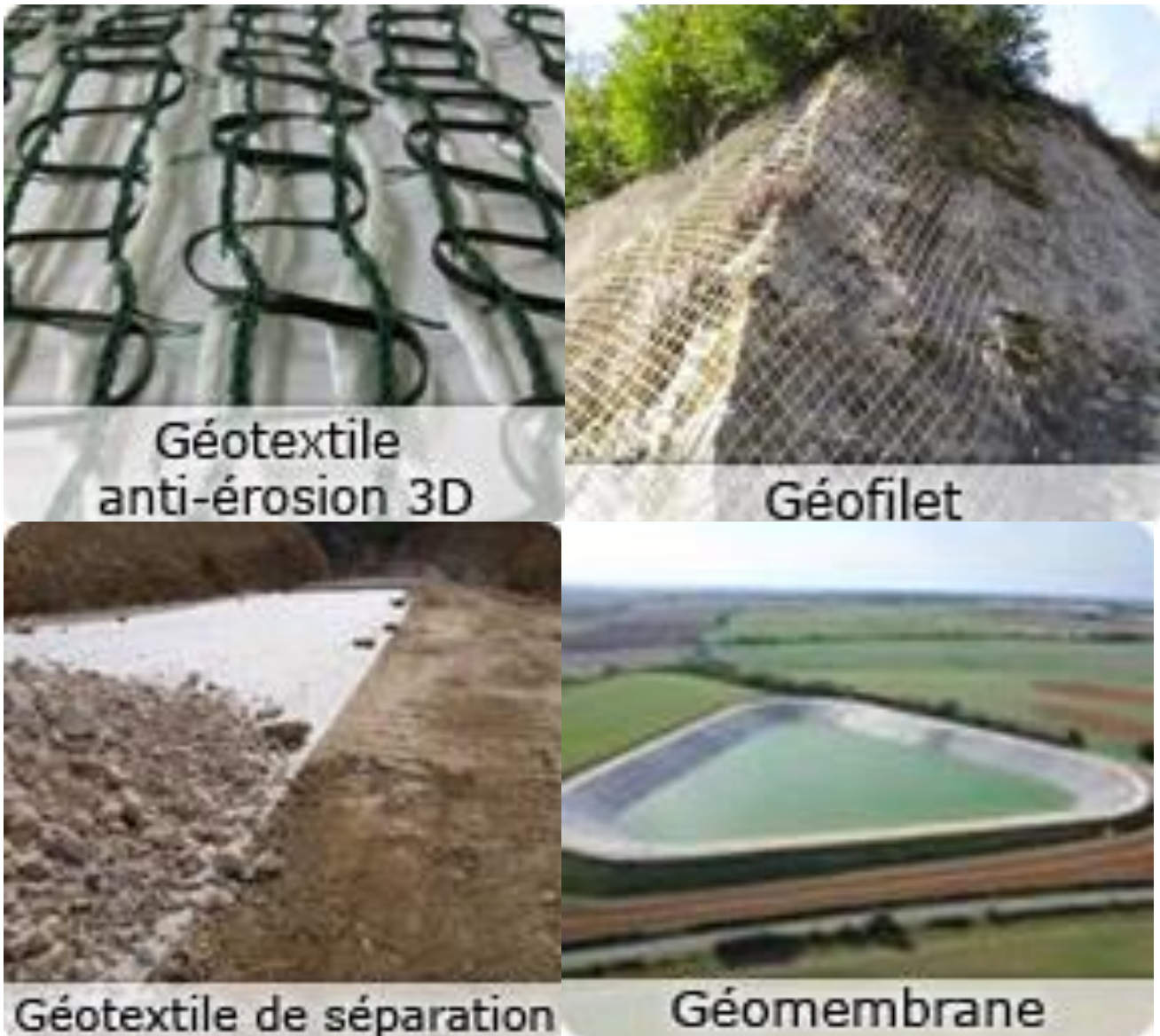
Figure 1. 5 A: Différents types des géosynthétiques (CFG, 2022)
