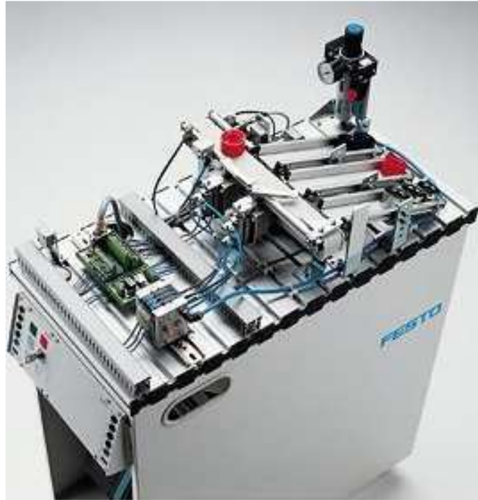
Figure 2.22 : Sous station de tri.
