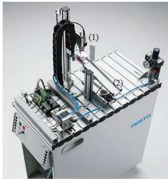
Figure 4.3 : Station de contrôle du MPS 500.
