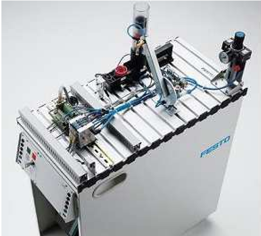
Figure 2.16 : Station de distribution de système MPS 500.
