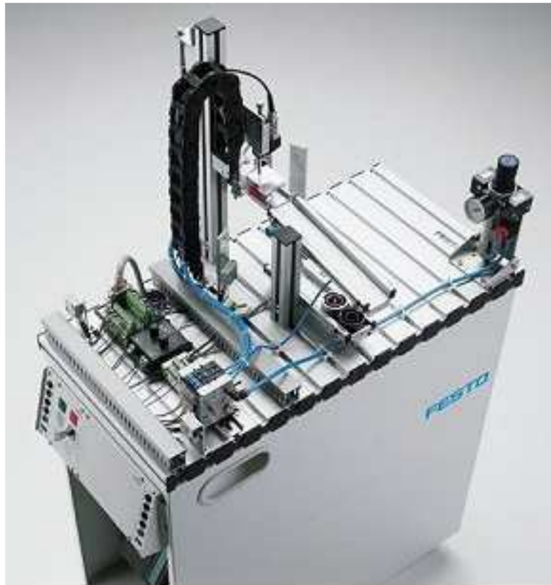
Figure 2.17 : Station de contrôle du système MPS 500.
