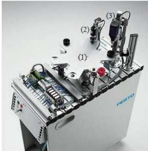
Figure 4.7 : Station d'usinage du MPS 500.
