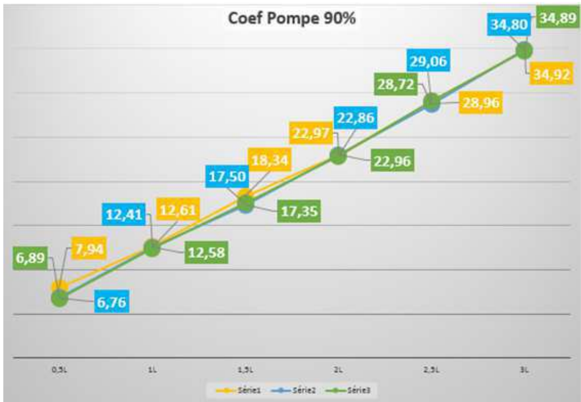
Figure 3.7 : Représentation graphique des essais de remplissage du réservoir cible avec un coefficient de pompe à 90%.
