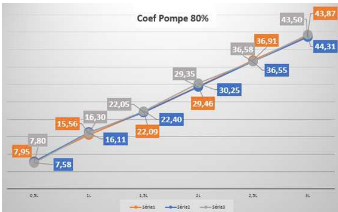
Figure 3.6: Représentation graphique des essais de remplissage du réservoir cible avec un coefficient de pompe à 80%.
