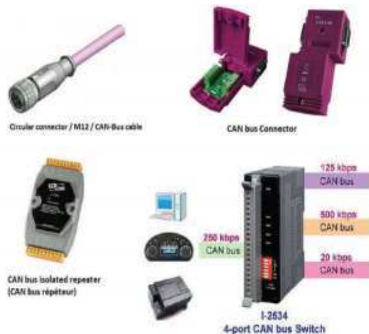
Figure 1.15 : Différents modèles de connecteur Bus CAN[67].
