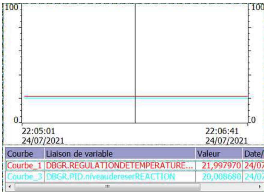
Figure 3.32 : IHM de la station réacteur de AFB de FESTO en mode Run.
