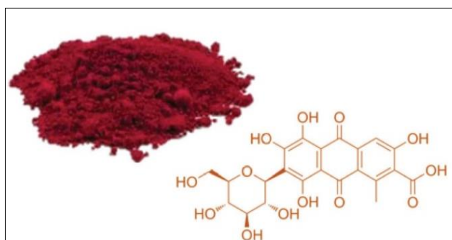
Figure 7 : Aspect visuel (poudre) et structure moléculaire de l'acide carminique (acide 7-Dglucopyranosyl-3,5,6,8-tétra-hydroxy-1-méthyl-9,10-dioxo-anthracène-2-carboxylique) (web1)
