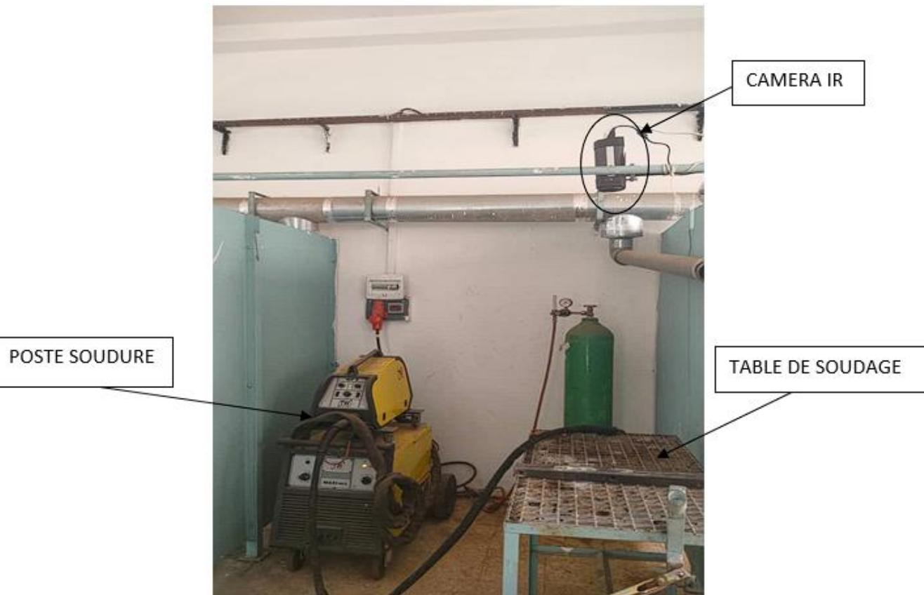
Figure V.8 Position de caméra infrarouge en poste de soudure
