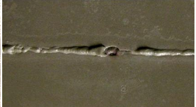
Figure III.25 Effondrement à plat ou au plafond Figure III.26 Effondrement en corniche [19]
