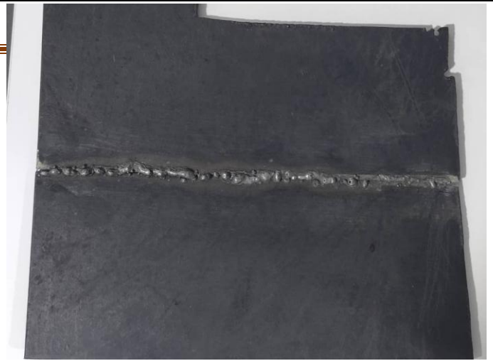
Figure V.5 Fil employé pour le soudage, les tôles après soudage
