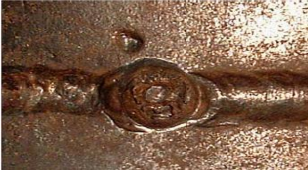
Figure III.25 Effondrement à plat ou au plafond Figure III.26 Effondrement en corniche [19]
