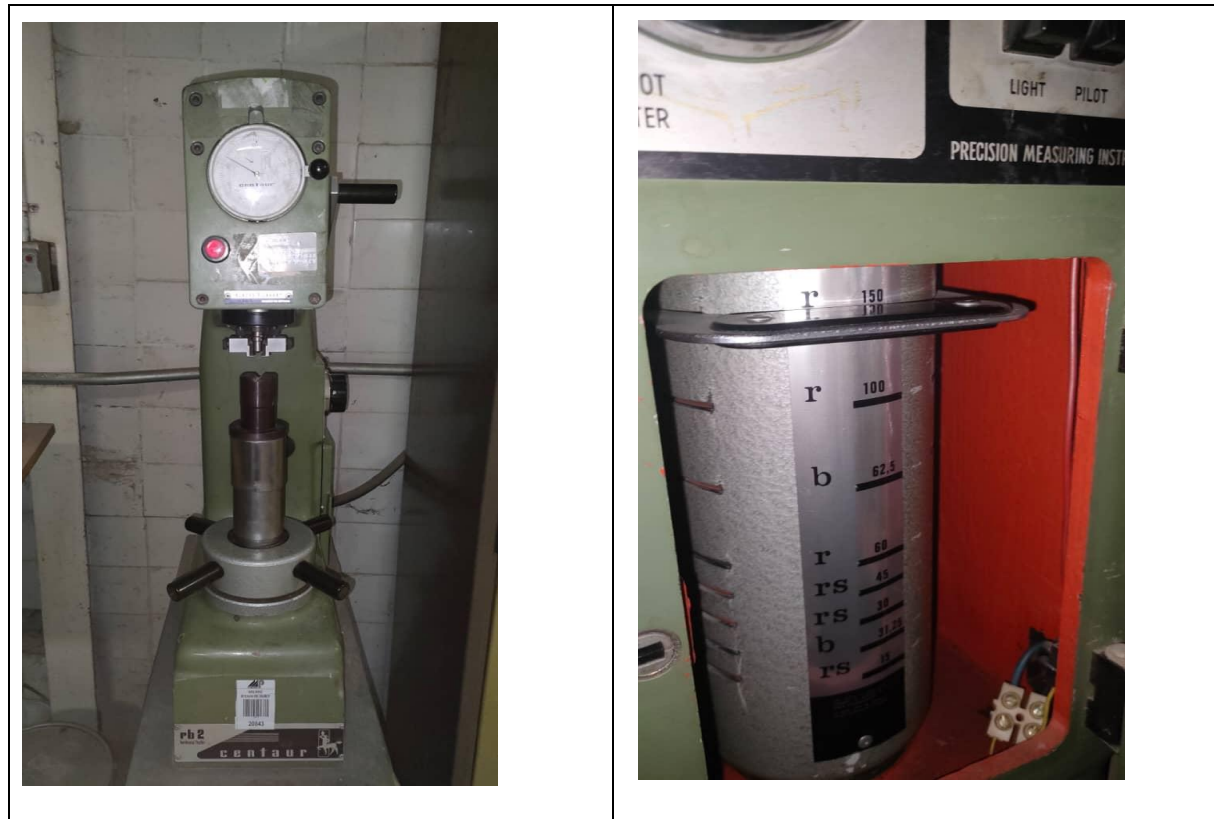
Figure V.20 Duromètre pour l'essai de dureté et la Charge appliquée de la machine
