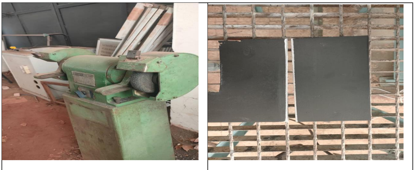
Figure V.4 Meuleuse pour le chanfreinage et les tôles après traitement de chanfrein.
