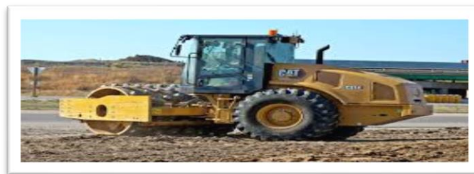
Photo 4.4.4.3) Compacteurs vibrants : couches granulaires [31]
