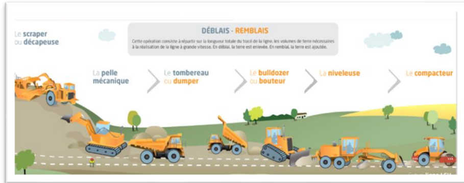
Photo 4.6.2) étapes déblai et remblai par engins [33]
