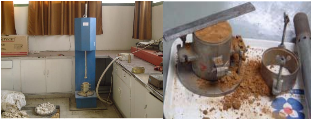
Photo 3.6.5.4) Essais de compactage (Proctor) [27]
