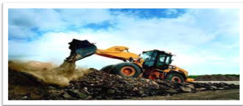
Photo 2.8.4) Chargeuse (ou Chargeuse frontale) [16]
