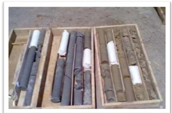
Photo 3.4.1.1) Caisses à carottes du sondage SC2[20]
