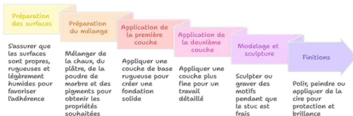
Figure 30 Technique de mise en œuvre du stuc (source : auteur du mémoire)
