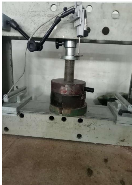
Figure 0-1 : Illustration d'un essai de compression simple d'une brique en terre comprimée.
