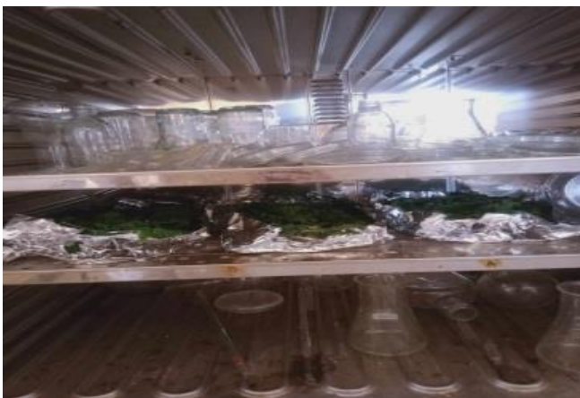
Figure 11: Disposition des échantillons à l'intérieur de l'étuve (originale 2025)
