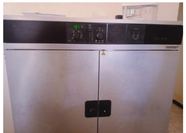
Figure 10: Étuve réglée à 105 °C pour le séchage (originale 2025)
