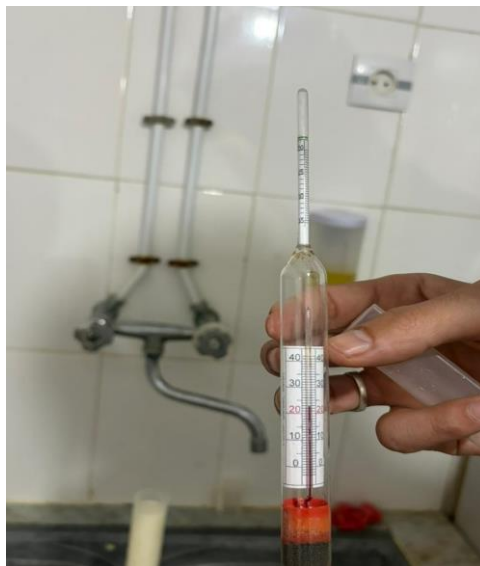
Figure N°4 : Mesure de la densité par un lactodensimètre
