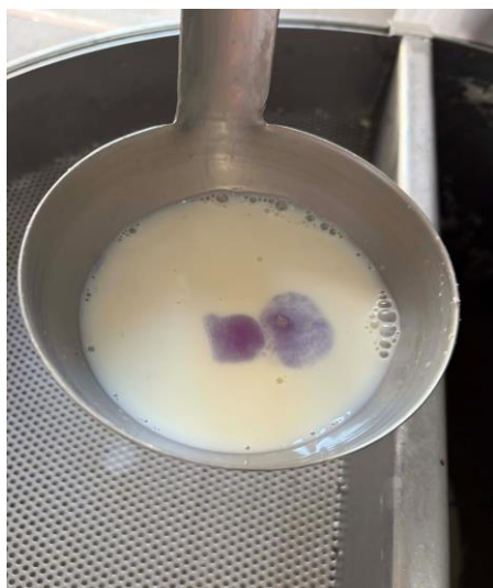
Figure N°2 : Contrôle de l'acidité par Bromocrésol
