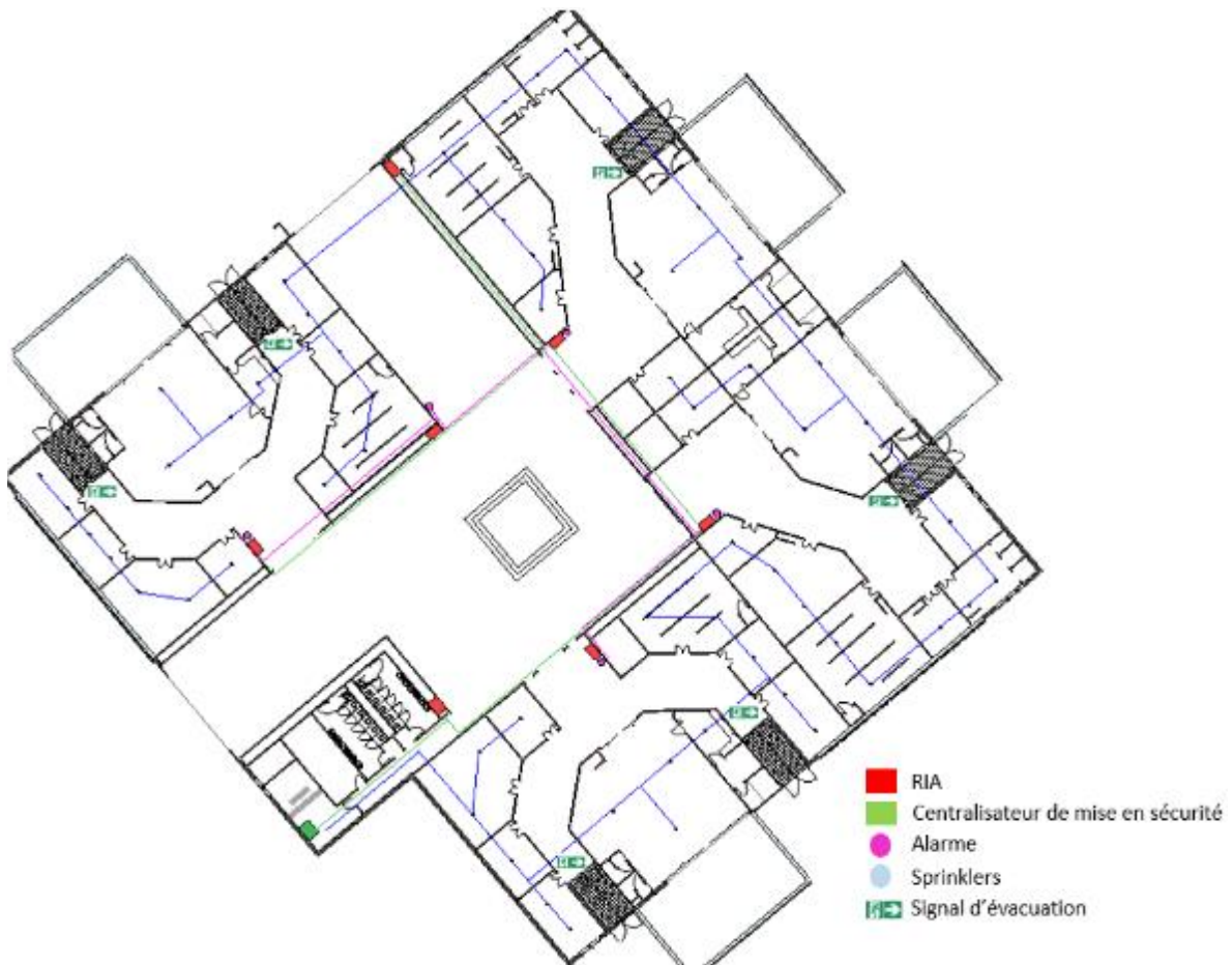
Figure 71 Plan schématique du système de protection anti-incendie des pavillons Source : auteur du mémoire
