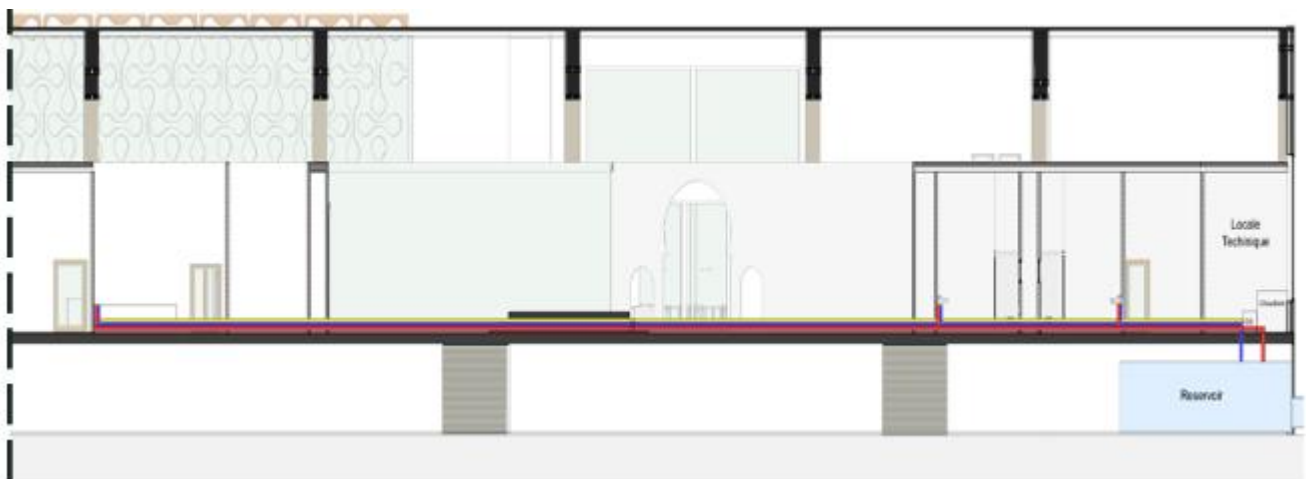
Figure 67 Coupe schématique de l'alimentation en AEP au niveau des pavillons Source : auteur du mémoire
