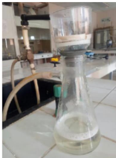
Figure II.9. Filtration sous vide.
