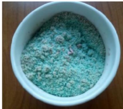
Figure II.2. Mélange bentonite/NaOH après chauffage de 3h à 550°C
