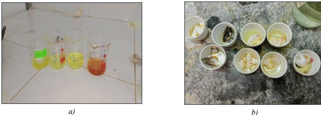
Figure 15 — Étapes de préparation et de minéralisation des matrices : a) solutions de minéralisation obtenues après digestion des tissus musculaires ; b) répartition des fragments de chair dans des creusets de porcelaine avant analyse.
