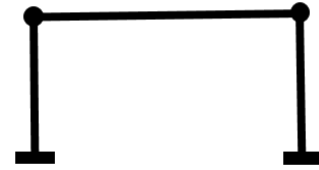
Figure 13 : Schéma d'un portique à pieds de poteaux articulés
