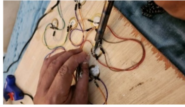
Figure 4 : Soudure et câblage des disques piézoélectriques
