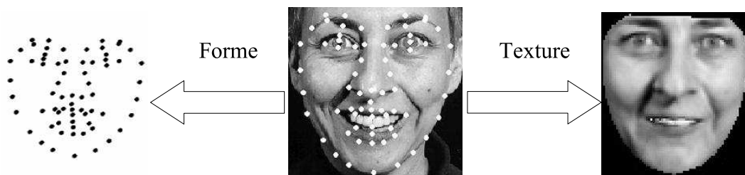
Figure 2.17- la méthode AAM incluant à la fois la forme et la texture.
