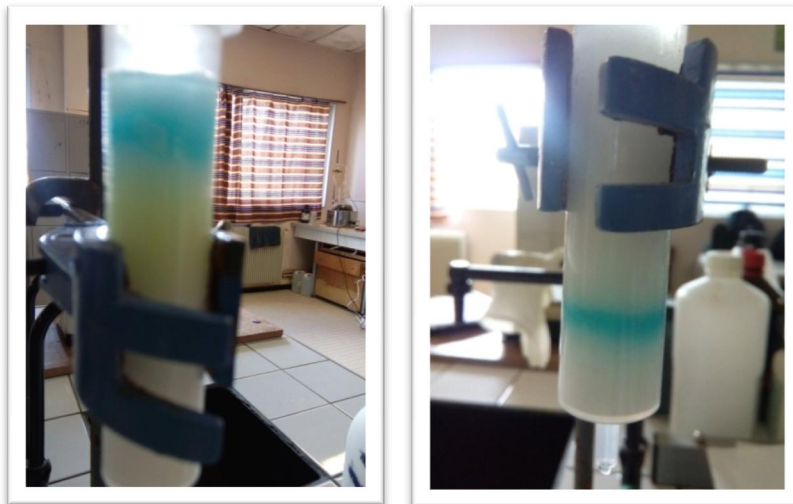
Figure 18 : Chromatographie sur colonne d'un sirop de menthe
