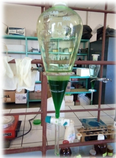
Figure 13 : Extraction liquide-liquide du sirop de menthe
