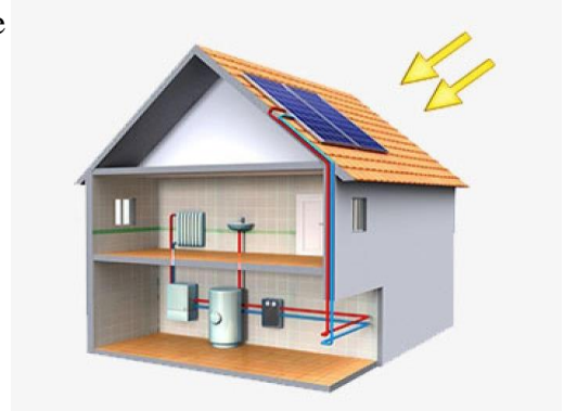
Figure I.18 : système solaire thermique combiné
