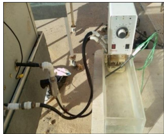
Figure II.5. Photo de l'appareil de source d'eau chaud et échangeur de chaleur à l'intérieur de la chambre de séchage
