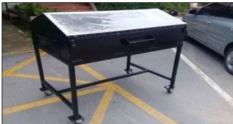
Figure II.10. Séchoir solaire à air chaud forcé [30]
