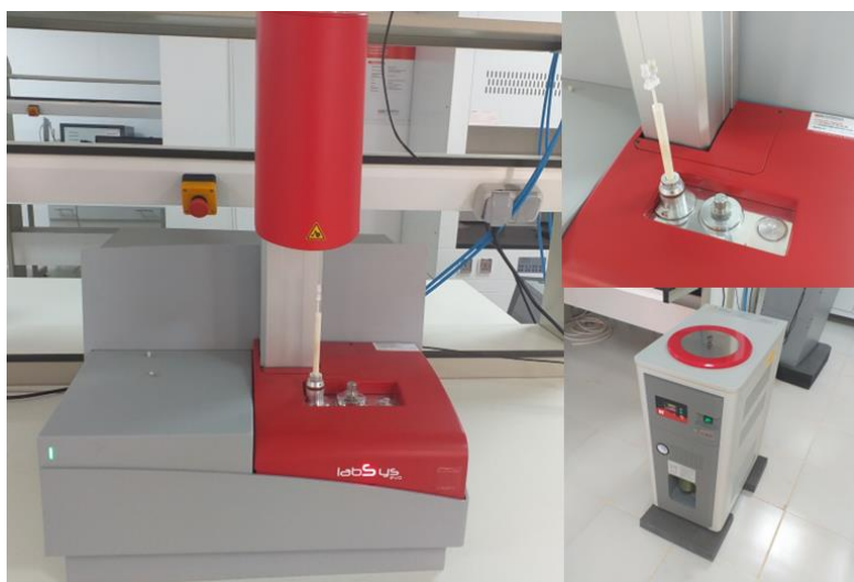
Figure II. 9: Analyse thermogravimétrique (LABSYS evo TGA).
