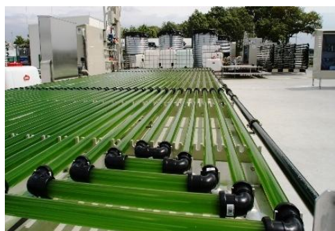
Figure I. 4 : Photographie des Photobioréacteurs tubulaires « A » ( https://newscientist.nl/ ), et plats « B » ( https://explorebiotech.com )
